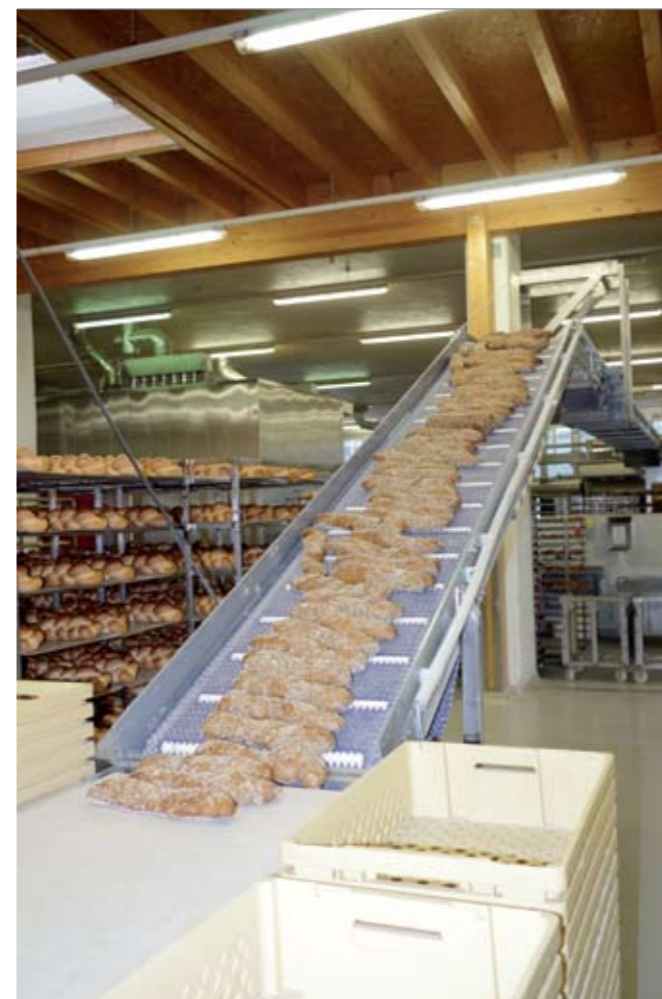
Załadunek i wypiekanie są zautomatyzowane. Włożyć chleby, wybrać półkę i wcisnąć start – wszystko inne przebiega automatycznie aż do transportu do konfekcjonowania.
